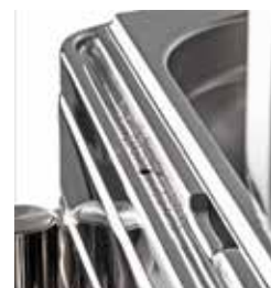
Zkondenzovaná voda se vrací zpátky do vodní lázně.
